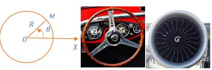
Le pont M est repéré : par la distance R constante par rapport à  $\mathcal{O}$  et par l'abscisse angulaire  $\theta$  Lorsque le point M s'est déplacé sur le cercle d'un angle  $\theta$ , il aura parcouru une distance d (arc de cercle) appelée : abscisse curviligne telle que :  $d[m] = R[m] \times \theta[rad]$
